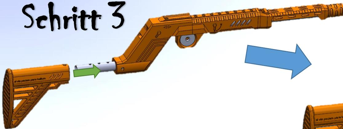
Führen Sie die Schraube durch den Schaft und schrauben Sie diese dann in die Mutter. Es gibt 3 Löcher, um die Griffposition einzustellen.
