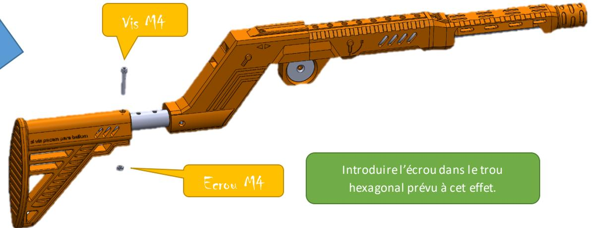
Introduire l'écrou dans le trou hexagonal prévu à cet effet.
