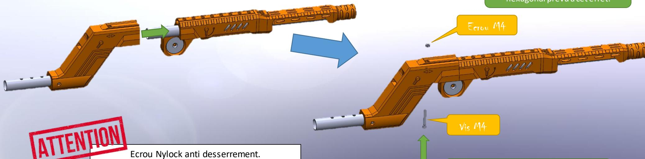
Introduire l'écrou dans le trou hexagonal prévu à cet effet.
